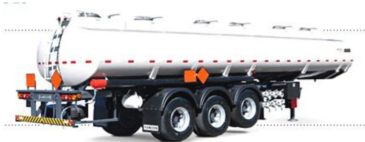
Figura 2 - Semirreboque tanque policêntrico construído em aço carbono
