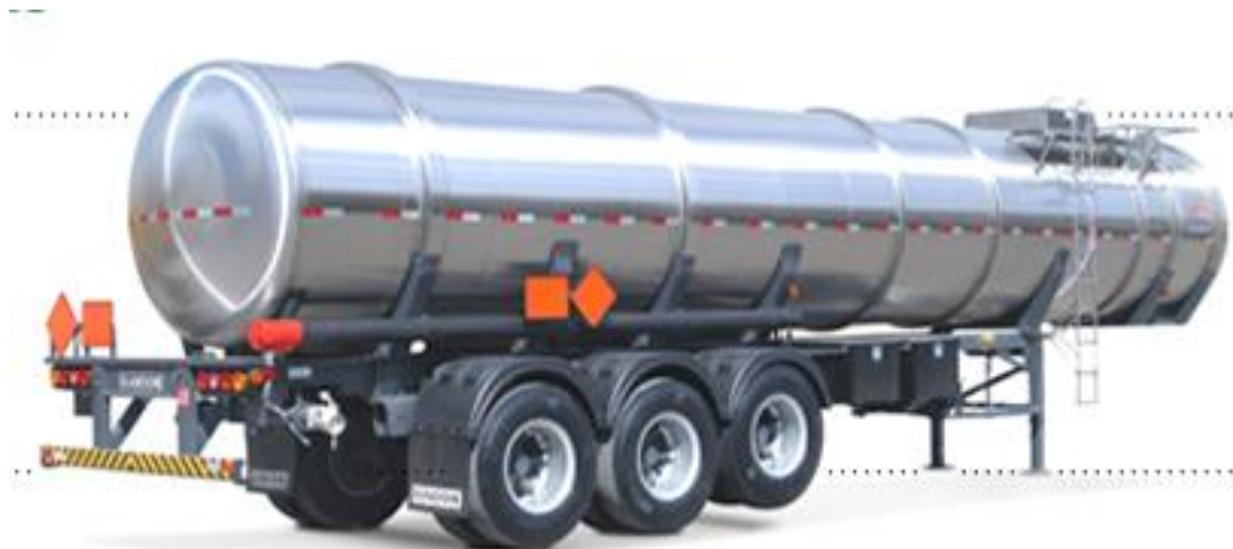
Figura 3 - Semirreboque tanque cilíndrico em aço inoxidável
