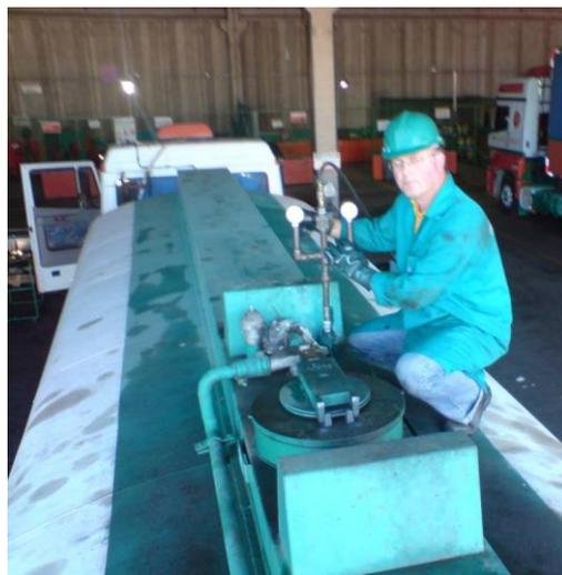
Figura 1: Ensaio hidrostático em tanque
